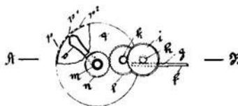
Volumen vergrößert, dadurch den Kolben d mit der Kolbenstange f vorwärts drückt und dessen Bewegung durch ein Zahngetriebe g, h, i, k, l auf ein bewegliches Rohr m überträgt, das mit einem von einem Gehäuse q umgebenen Austrittsstutzen o für die Destillationsdämpfe versehen ist, durch dessen Öffnungen p, p<sup>1</sup>, p<sup>2</sup> usw. die Dämpfe bei einer bestimmten Temperatur in die den Öffnungen vorgelagerten Kühlapparate entweichen. --
